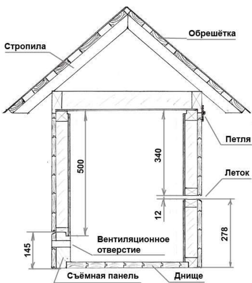
Вертикальный разрез улья
